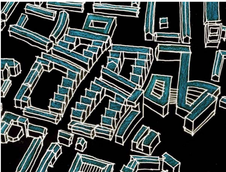
Isometrie Ausschnitt Bereich Altmarkt und Kurt-Schumacher-Strasse Denkbar ist eine kleinteilige Struktur durch Parzellierung der Flächen zu verkauf fähigen Einzelgrundstücken. Dadurch entsteht eine strukturierte und durchmischte Bebauung
